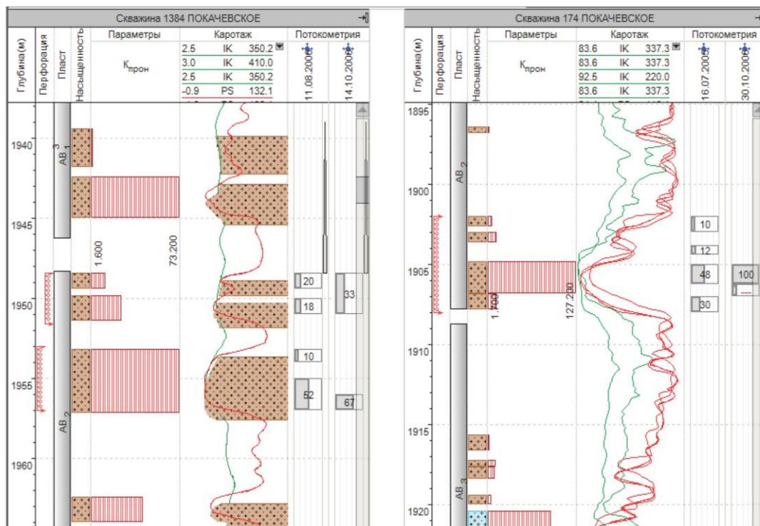
*Рис. 3.1. Выделение работающих толщин до и после применения ФХВна скважинах методом ГИС-контроля*
