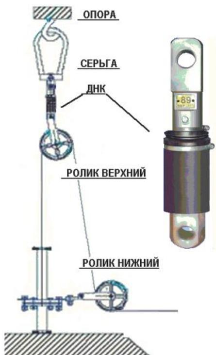
*Рис. 5.3.4. Датчик натяжения кабеля*
